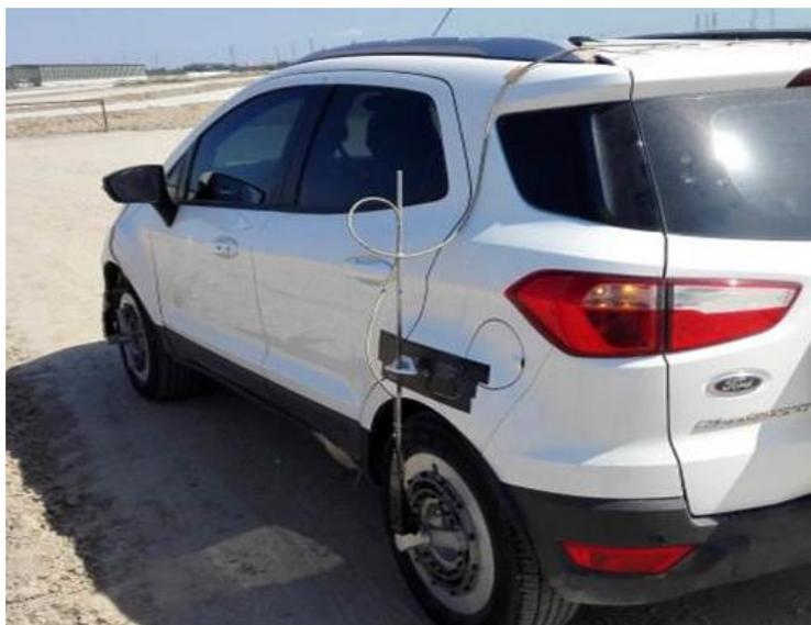
图 5.7 车轮六分力传感器安装
