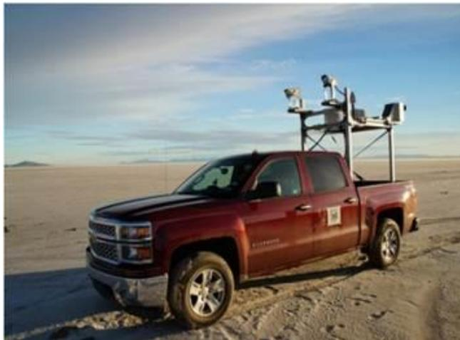
图 3.9 车载激光扫描仪
