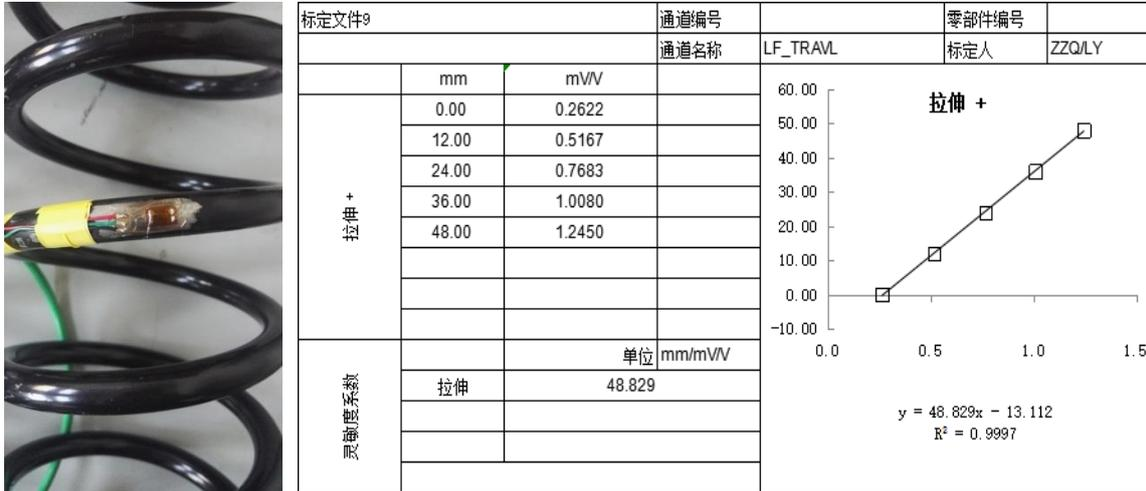
图 5.1 左前弹簧贴片示例与传感器标定结果
